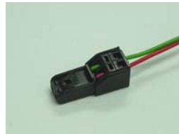
3. 纜線完成壓入
