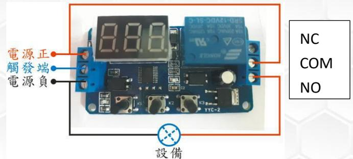
P-1：信號觸發後繼電器開始導通，計時時間到了，繼電器斷開，在延時期間
