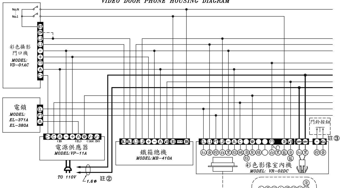
註: ① 管路末端請加 $75\Omega$ 阻抗(分機VR-02DC右下方可切換)。
