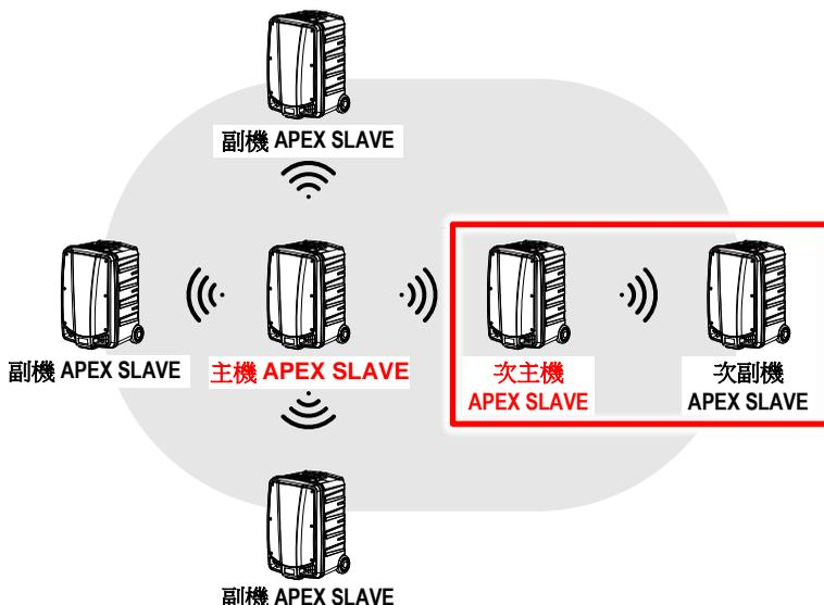
為達此效果，請在次主機上安裝一個發射模組，在第三階機器上安裝接收模組（設定方式同步步驟 1 和 2）。發射模組和接收模組必須設定在相同的頻道/頻率，並且不可和系統內已安裝的發射及接收模組。
