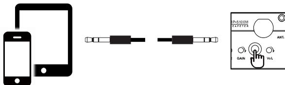
2 音量的大小可由小螺絲起子調整，順(逆)時針方向為提高(降低)。
