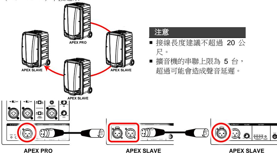
**2** 開啟 APEX PRO 的與所有已串接的 APEX SLAVE 主動式喇叭的電源，再依使用需求，將 APEX PRO 主機與其它 APEX SLAVE 主動式喇叭音量調整到適當大小。
